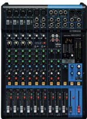
La Yamaha MG12XU es una consola analógica de 12 canales que ofrece una combinación de calidad de sonido profesional, efectos digitales SPX y una interfaz de audio USB integrada. Con una construcción robusta y características avanzadas, es ideal para aplicaciones en vivo, grabaciones y producciones multimedia.
