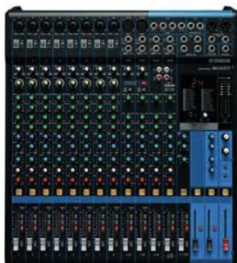
La Yamaha MG16XU es una consola analógica de 16 canales que ofrece una combinación de calidad de sonido profesional, efectos digitales SPX y una interfaz de audio USB integrada. Con una construcción robusta y características avanzadas, es ideal para aplicaciones en vivo, grabaciones y producciones multimedia.
